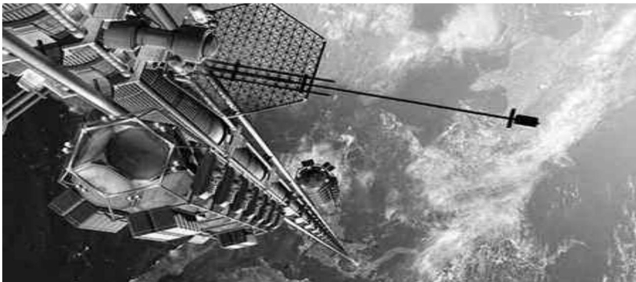
Un ascenseur spatial est un nouveau type de transporteur spatial, permettant d'amener en orbite des charges lourdes sans utiliser de lanceurs spatiaux. Il s'agit de tendre un câble entre la surface terrestre, ancrée au niveau de l'équateur, et une masse située au-delà de l'orbite géostationnaire. La câble se retrouve naturellement tendu par la force centrifuge, telle une fronde dont la rotation est entraînée par la rotation même de la planète.
