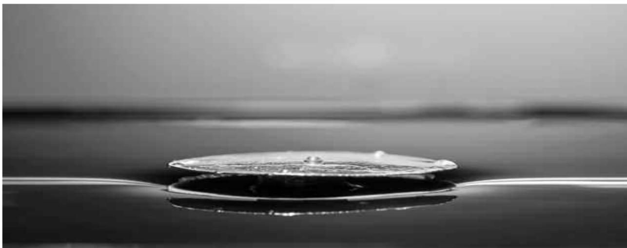
Un bateau insubmersible, ou un dispositif de flottaison qui continue de fonctionner après avoir été perforé : c'est peut-être ce que des chercheurs pourront bientôt proposer grâce à une structure métallique inspirée d'araignées et de fourmis.
