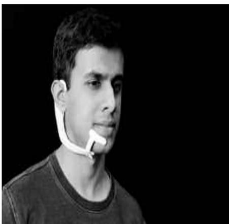
Conçu par les chercheurs du MIT, le gadget exploite des électrodes pour capter les signaux générés par une personne qui parle dans sa tête. Le système comporte aussi des écouteurs à conduction osseuse, qui envoient des vibrations aux os de l'oreille interne sans obstruer le conduit auditif. Les informations sont ensuite envoyées à un ordinateur qui parvient à déchiffrer les mots grâce à ses réseaux de neurones.
