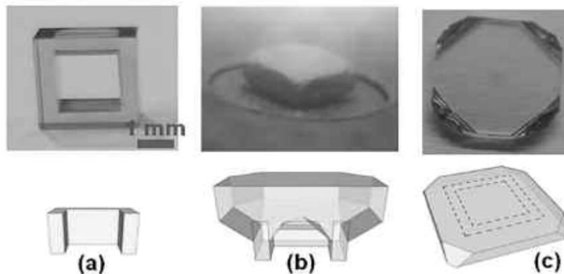
Croissance d'un monocristal de diamant CVD à partir d'un substrat germe de diamant ajouré (a). La croissance du film jusqu'à coalescence (b) permet d'obtenir une plaque de diamant contenant une faible densité de dislocations (c).
